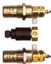
Система предпускового разогрева с факельными свечами накаливания (модели 310000 - 500000). Данная система разогрева аналогична системе с нагревательным фланцем, но в дополнение к электрическому подогреву предусмотрена форсунка, распыляющая дизельное топливо. Выделенное при его горении тепло нагревает воздух до высокой температуры. Факельные свечи накаливания установлены перед электрическим нагревателем (модели 310000 - 500000).
