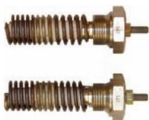
Система предпускового разогрева со стержневыми свечами накаливания (модели 20000, 30000 и 40000). Стержневые свечи накаливания устанавливаются в впускной воздушный коллектор. Проходящий через стержневые свечи электрический ток, нагревает их, а они, в свою очередь, нагревают всасываемый в камеры сгорания двигателя воздух. Таким образом улучшается пуск двигателя при низкой температуре.
